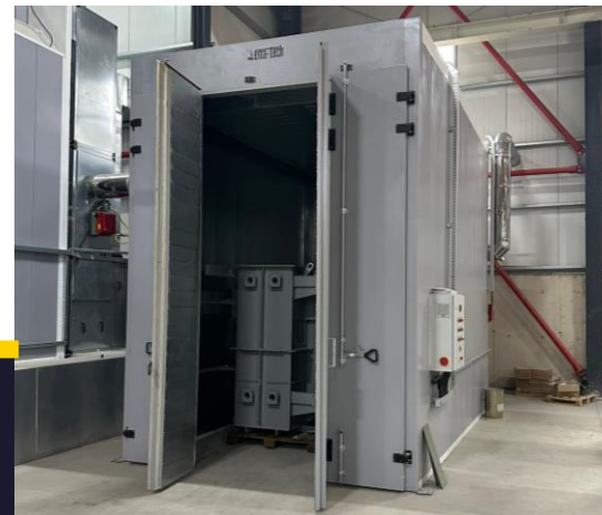
Trockenofen 2.000 mm x 15 mm
